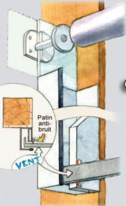
Les tubes raidisseurs sont équipés de pattes anti-arrachement, qui ne peuvent sortir des coulisses lors des tempêtes.
