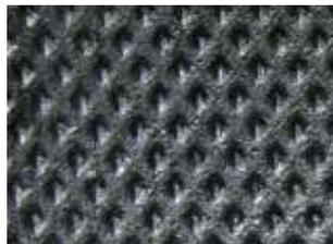
Profil inférieur : crampons coniques de 5 mm de hauteur, déformables
