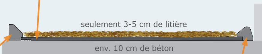
**maxiSTEP** - profil caoutchouc à l'arrière :
